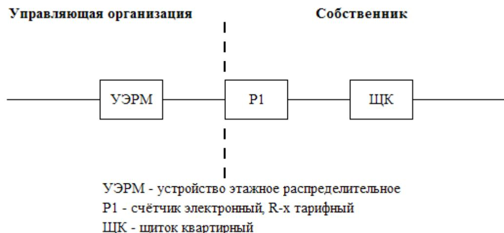
Исполнитель (управляющая организация) несет ответственность за надлежащее состояние и работоспособность питающих электрических сетей на квартиру согласно вышеуказанной схеме до прибора учета (пунктирной линии слева).
